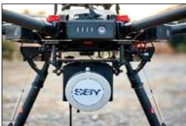
DJI MATRICE 600 LIDAR RTK/PPK
